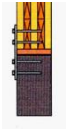
Slika 31.: Spajanje montažnog zida s betonskim temeljem (Izvor: [38])
