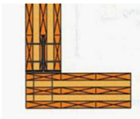
Slika 25.: Povezivanje CLT zidova utisnutim limom (Izvor: [38])
