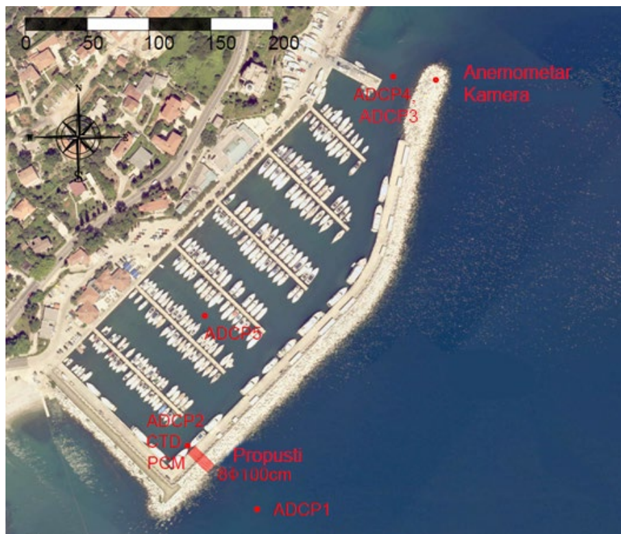
Slika 24 Tlocrtni prikaz ACI marine Opatija s pripadnim pozicijama instrumenata za mjerenje za ljetno razdoblje mjerenja (4.7.2017 – 31.8.2017) (instrumenti opisani u okviru poglavlja 4.2.2)
