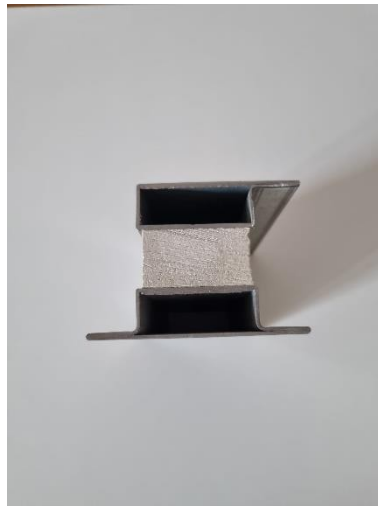
Slika 5. Čelični profil ispunjen kalcij silikatnom pločom
