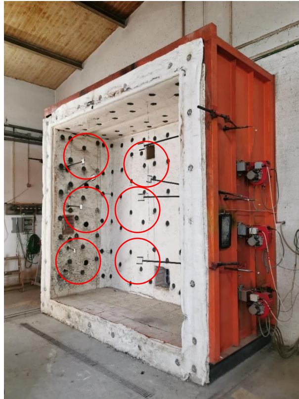
Slika 11. Postava termoparova za mjerenje temperature peći
