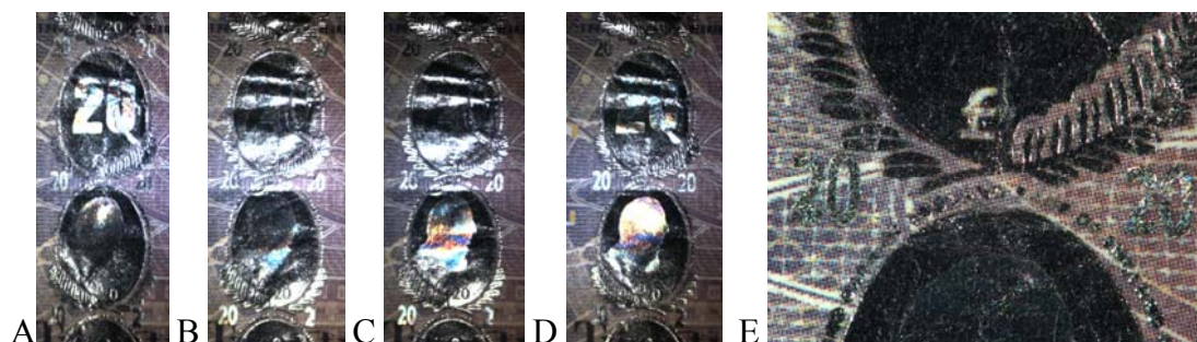
Slika 48. Reprodukcijske verzije holograma na krivotvorenoj novčanici od 20 britanskih funti , uvećanje 7,4 puta. Ring skeniranje (A,B,C,D) i detalj uvećan 29 puta, imitacija bijelog svjetla (E).
