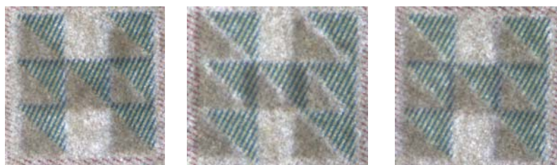
Slika 45 Detalji prozirnog registra krivotvorenih novčanica od 500 kuna, indikativa 185. Propusno svjetlo, uvećanje 29 puta
