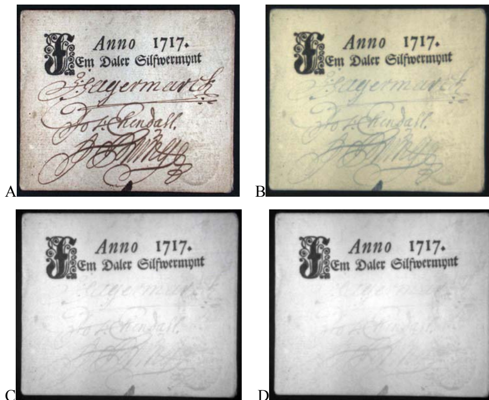
Slika 22 Švedska novčanica iz 1717.godine, i.b. 1397, uvećanje 3,4 puta. Imitacija dnevnog svjetla (A), infracrveno svjetlo od 715 nm (B), 830 nm (C) i 1000 nm (D).
