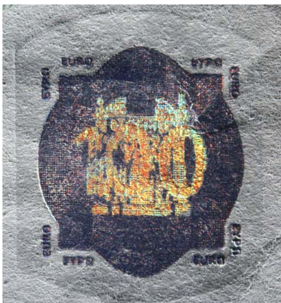
Slika 57. Reprodukcijski hologram na krivotvorenoj novčanici od 100 eura indikatora P13, uvećanje 13 puta, koso obostrano svjetlo.
