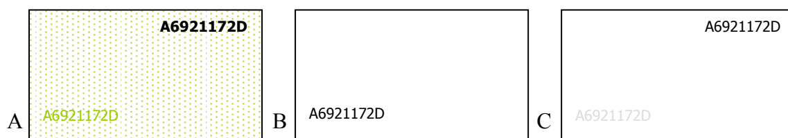
Slika 96. Prijedlog skrivene numeracije pod vidljivim svjetlom (A), IR svjetlom od 830 nm (B) i očekivana imitacija (C)
