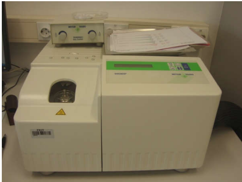
Slika28 - Mettler Toledo DSC 823e
