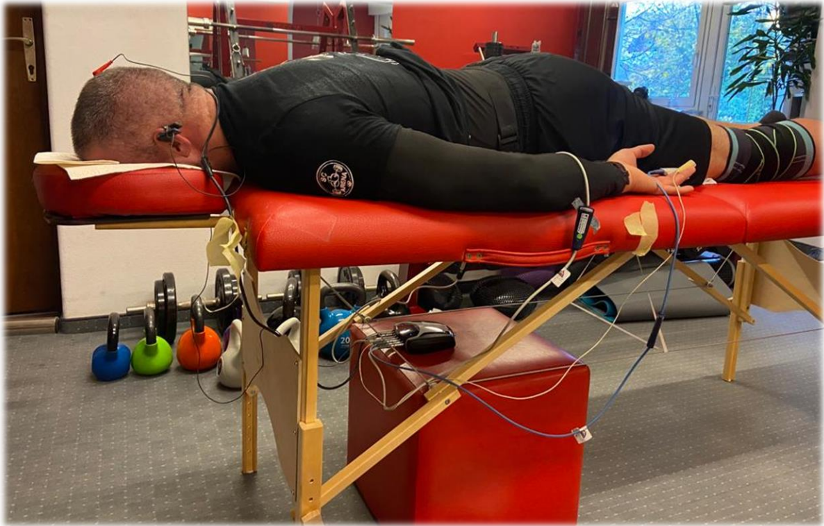
Slika 13 – Prikaz mjerenja ispitanika gdje je vidljiv mjerni uređaj ispod ispitanika i priključeni senzori EEG-a, HRV-a, respiracije i temperature kože
