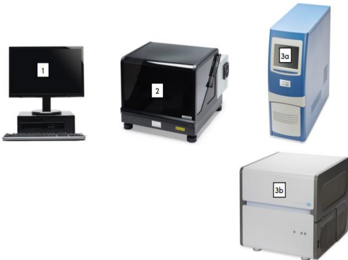
Slika 13. Komponente uređaja High-Plex 24 System: 1. Kompjutor sa softverskim programom 2. MT Procesor, 3a. MT Analizator, 3b. Roche Analyser LC480 (opcionarno)
