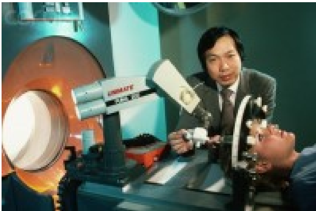
Slika 3. Prva uspješna operacija robotskim sustavom bila je obavljena 1985. industrijskim robotskim sustavom PUMA 200 [16]
