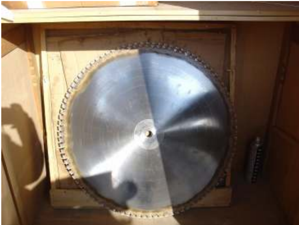
Slika 2. List kružne pile – oštrica iz tvrdih ili sinteriranih metala (sadržaj: volframovi karbidi, nikel i željezo)
