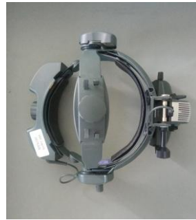
Slika 2. Binokularni neizravni oftalmoskop
