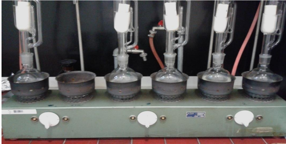
Slika 8. Određivanje masti po Soxhlet-u (vlastiti izvor)
