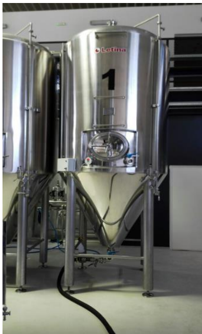
Slika 4. Cilindrično-konusni fermentor (zapremnine 4000 L), Zmajška pivovara d.o.o. (Stegnjaić, 2017)
