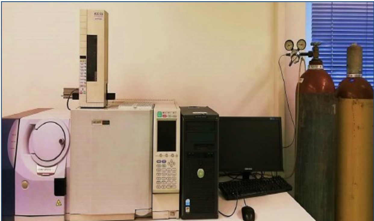
Slika 3. Plinski kromatograf s masenim spektrofotometrom (GC-MS), Shimadzu QP2010PLUS, Japan.
