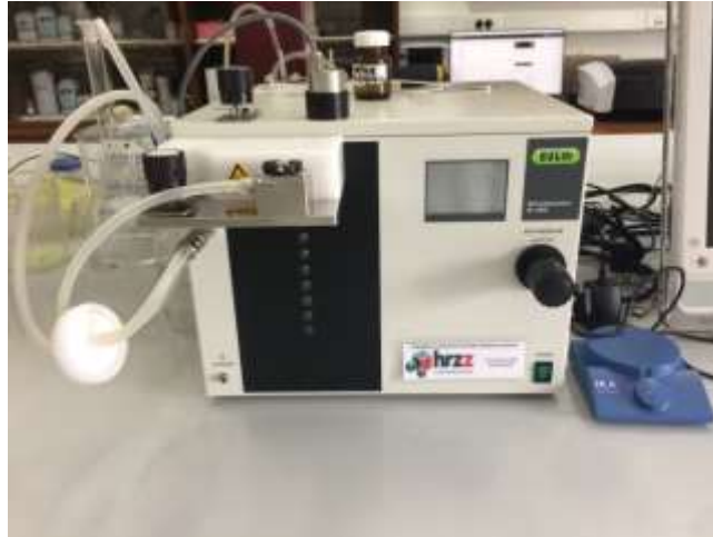
Slika 6. Inkapsulator (Büchi Encapsulator B-390, Büchi Labortechnik AG, Flawil, Švicarska)
