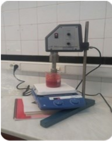
Slika 4. (ultrazvučni tretman pirea jagode)
