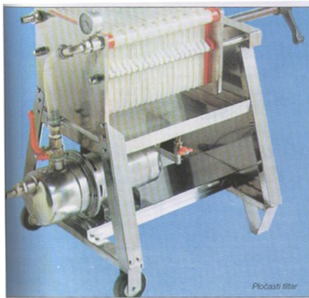
Slika 3. Pločasti filter i princip rada (Zoričić, 1996, a).
