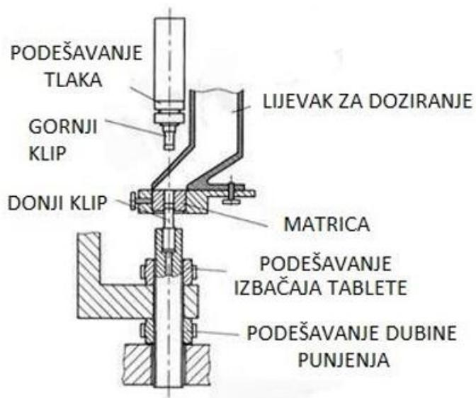
Slika 3. Shematski prikazana ekscentrična tabletirka (Gretić, 2015)
