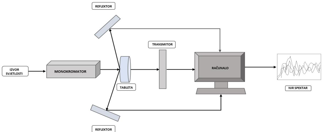
**Slika 5.** Osnovni princip rada NIR spektrometra (Vivek i sur., 2017)
