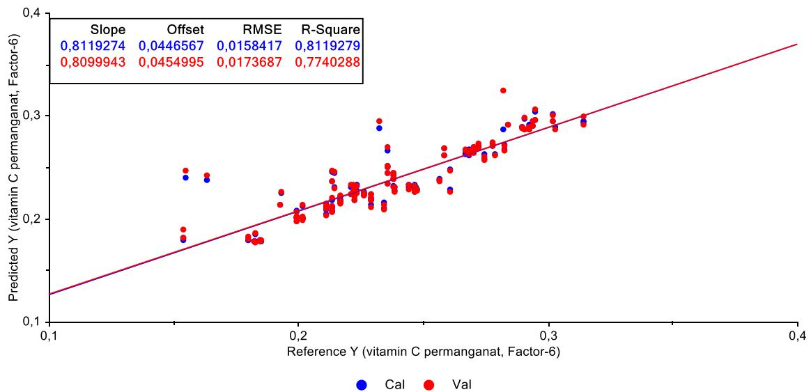
**Slika 19.** PLS modeli razvijeni za predikciju koncentracija vitamina C u tabletama određene spektrofotometrijski kalijevim permanganatom
