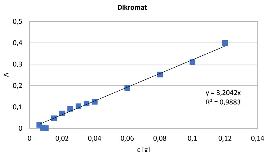
**Slika 8.** Baždarni dijagram ovisnosti apsorbancije o koncentraciji vitamina C određeno spektrofotometrijskom metodom pomoću kalijevga dikromata
