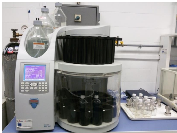
Slika 7. ASE uređaj (Dionex ASE 350, proizvođača Thermo Scientific; vlastita fotografija)
