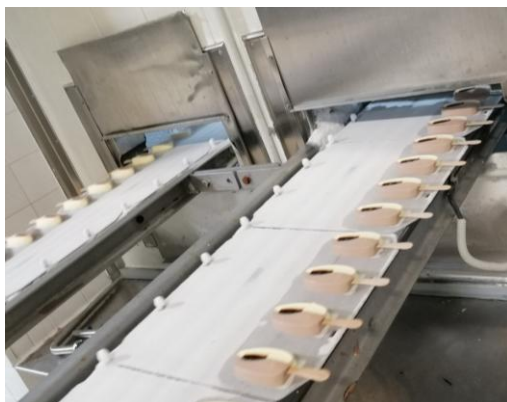
Slika 17. Odlazak King Obsession sladoleda na tacni konvejerom u tunel za duboko zamrzavanje (Ledo plus d.o.o. vlastita fotografija, 2021)
