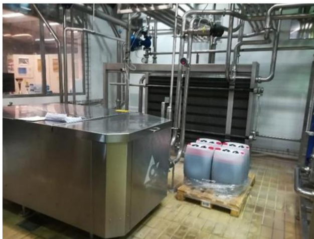
Slika 15. Pločasti pasterizator i homogenizator u Ledo plus d.o.o. (Tudor Kalit, 2019)
