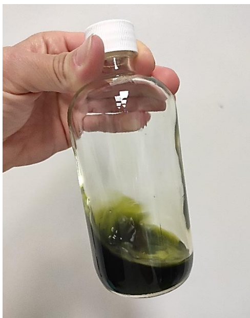
Slika 7. Ekstrakt lista pasjeg trna skupljeni u staklenu ekstrakcijsku bočicu, prije razrjeđivanja ekstrakcijskim otapalom ( vlastita fotografija )
