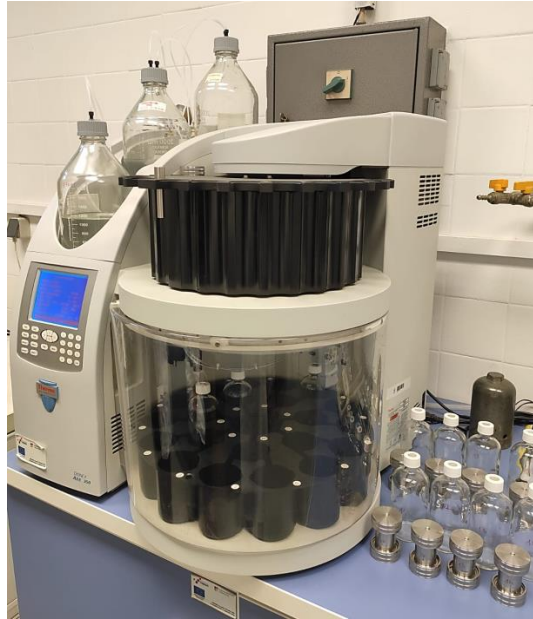
Slika 6. Ekstraktor ASE™ 350 (lijevo) i pripremljeni uzorci u ekstrakcijskim ćelijama (desno) ( vlastita fotografija )
