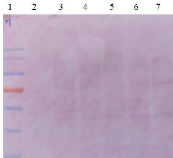
Slika 9. Nitrocelulozna membrana obojana Ponceau bojom
