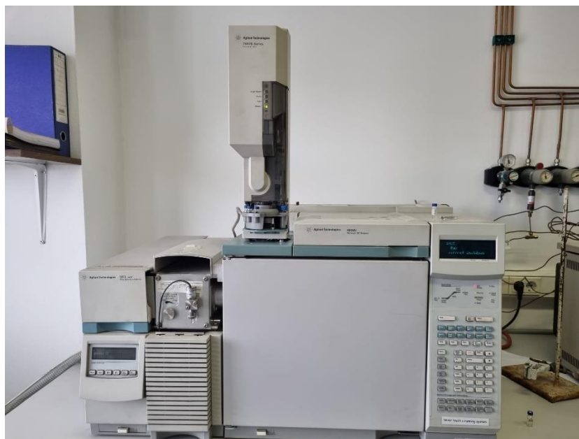
Slika 7. Plinski kromatograf Agilent Technologies 6890N Network (vlastita fotografija)
