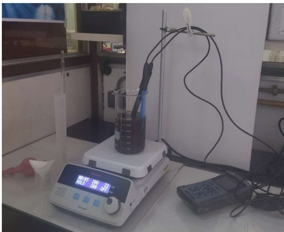
Slika 7. Aparatura korištena za šaržne pokuse denitrifikacije
