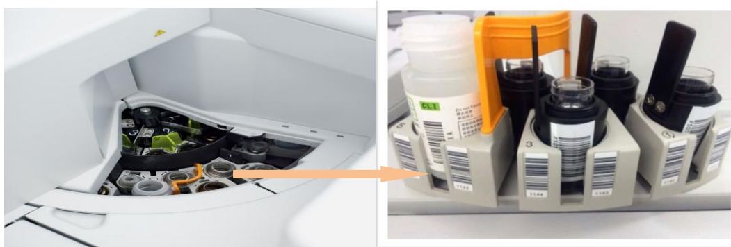
Slika 11. Stavljavanje otopine za čišćenje (Cl I) i čašica s radnim otopinama reagensa i fiziološkom otopinom u odgovarajućim adapterima (crni nosači) u analizator
