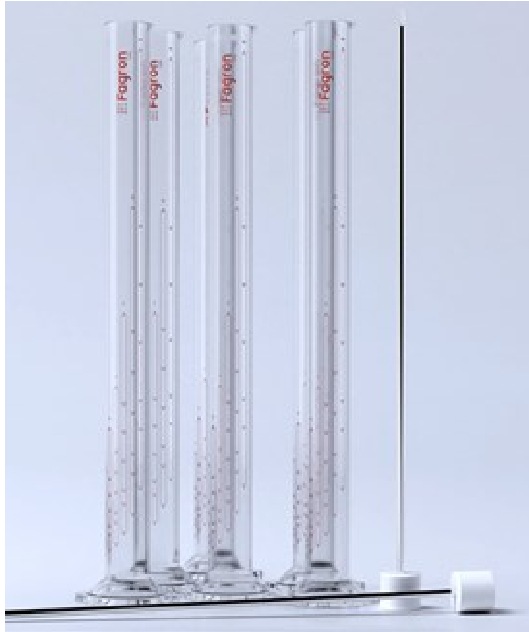
Slika 2. Specijalno graduirana menzura FagronLab™ MedCaps za bržu izradu kapsula (komplet sa sabijalom)
