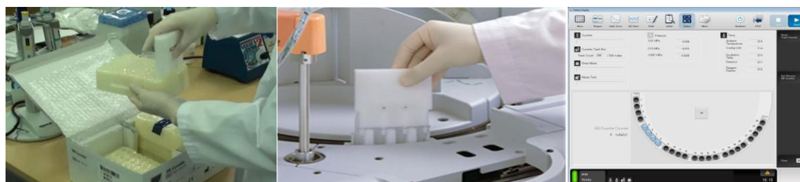
Slika 12. Uzimanje reakcijskih kivetica s magnetnim štapićem pomoću metalnog držača, stavljanje u analizator i prikaz izbornika u analizatoru s postavljenim kivetama
