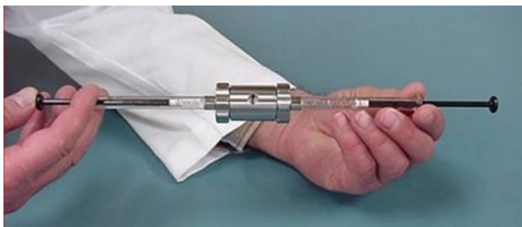
Slika 5. Ručni mini ekstruder ( http://www.avestin.com/ )
