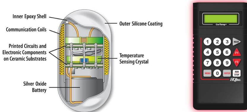
Slika 6. Građa „pametne pilule“ CorTemp (lijevo) i vanjska jedinica za očitavanje signala i prikazivanje izmjerene temperature (desno) (preuzeto i prilagođeno s: <https://hqinc.net/cortemp>).
