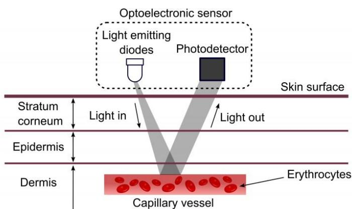
Slika 1. Princip rada fotopletizmografskog senzora (preuzeto i prilagođeno iz Moraes i sur., 2018).
