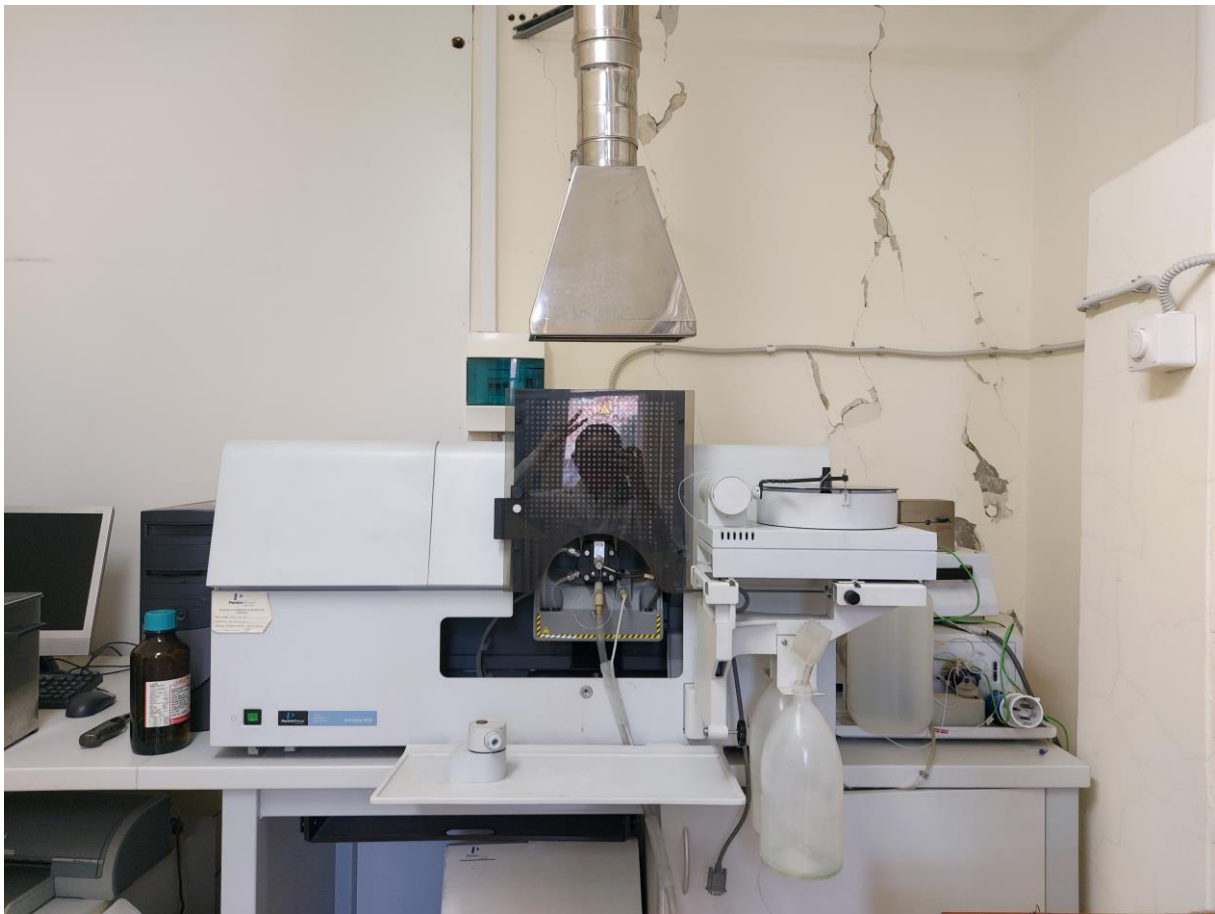
Slika 4. Plameni atomski apsorpcijski spektrometar u laboratoriju Zavoda za Analitičku kemiju na Farmaceutsko-biokemijskom fakultetu
