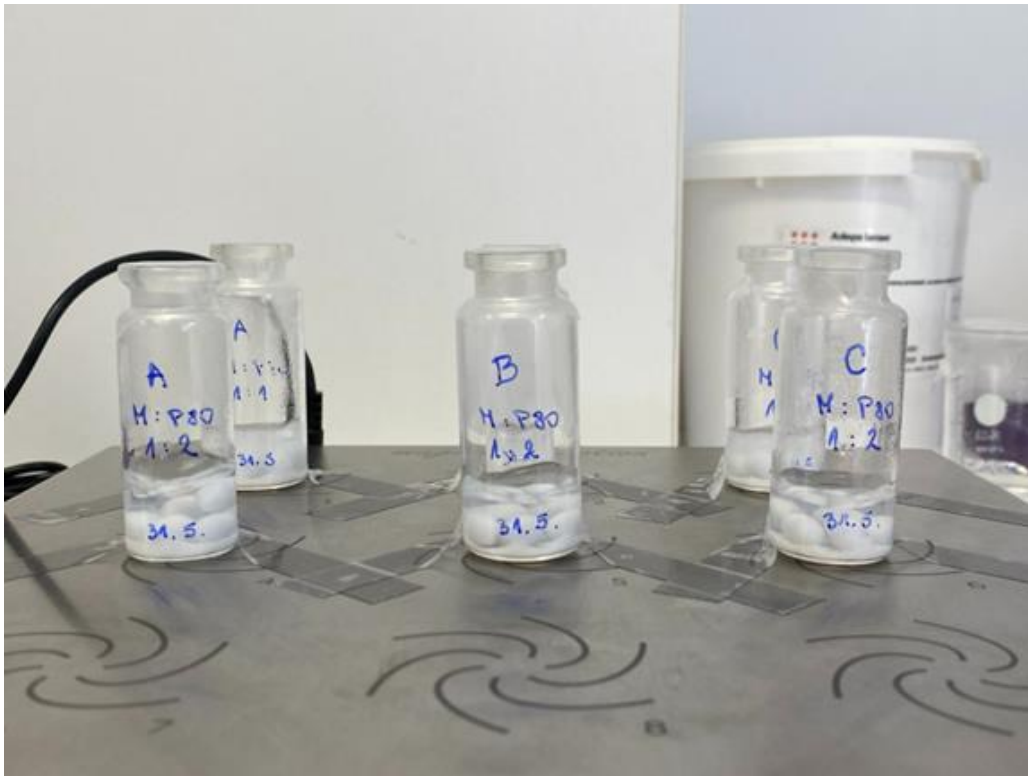
Slika 1. Prikaz pripreve nanosuspenzija melatonina metodom vlažnog mljevenja
