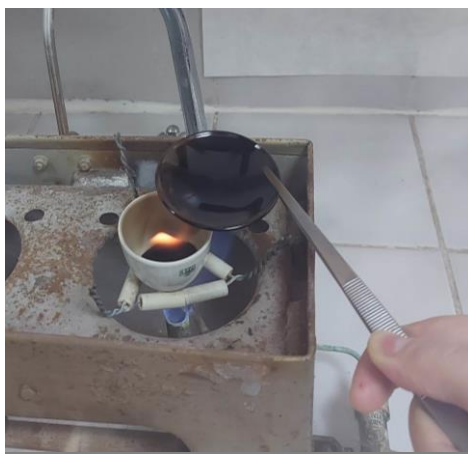
Slika 2. Postupak spaljivanja na plameniku u užarenom lončiću
