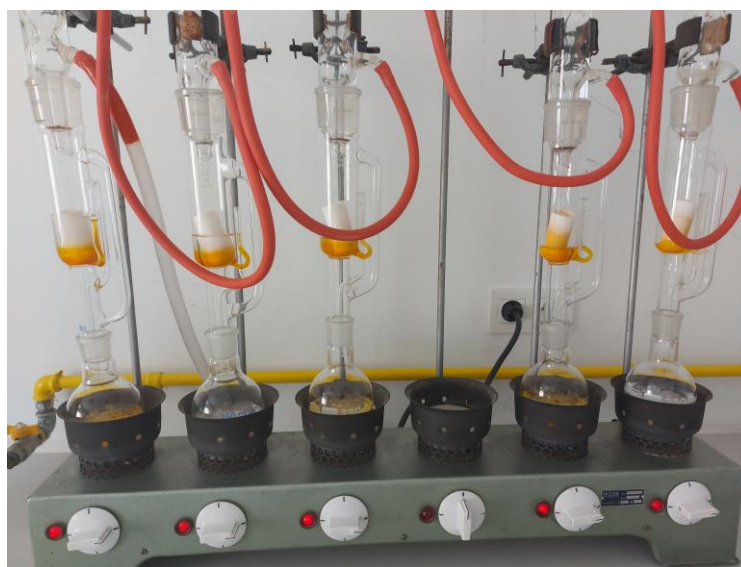
Slika 3. Ekstrakcija lipida po Soxhletu
