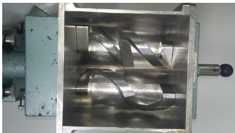
Slika 1.(b) Nastavak za vlažnu granulaciju, pogled odozgo
