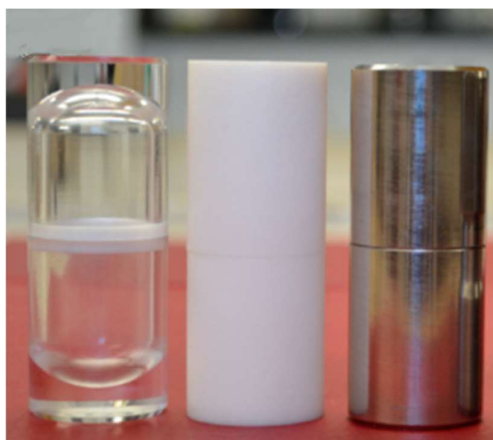
Slika 16. Različite vrste mehanokemijskih reakcijskih posudica (PMMA, teflon, nehrđajući čelik) 42
