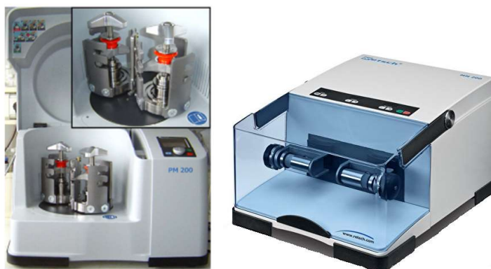
Slika 14. Kuglični planetarni (lijevo) i vibracijski (desno) mlinovi za mehanokemijske reakcije 45
