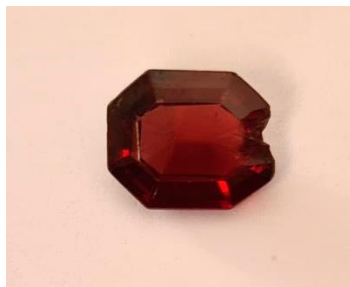
Slika 7: Uzorak CRN3 sa velikom bočnom pukotinom na desnoj strani
