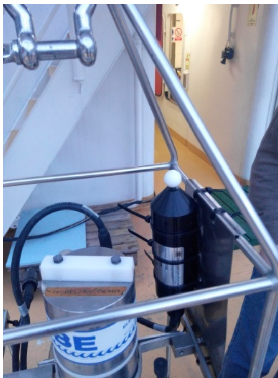
Slika 10. Bio-optički senzor za mjerenje fotosintetski aktivne radijacije -PAR
