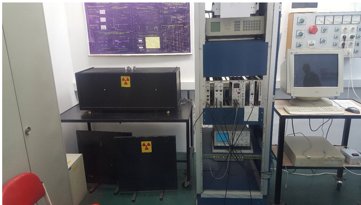
Slika 9. Mössbauerov spektrometar, sa ^{57}\text{Co} u rodijevoj matrici kao izvorom zračenja
