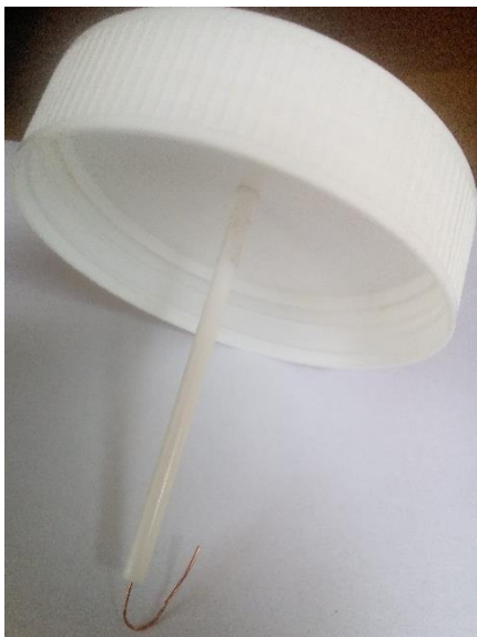
Slika 3.5. Kukica s unutarnje strane poklopca.
