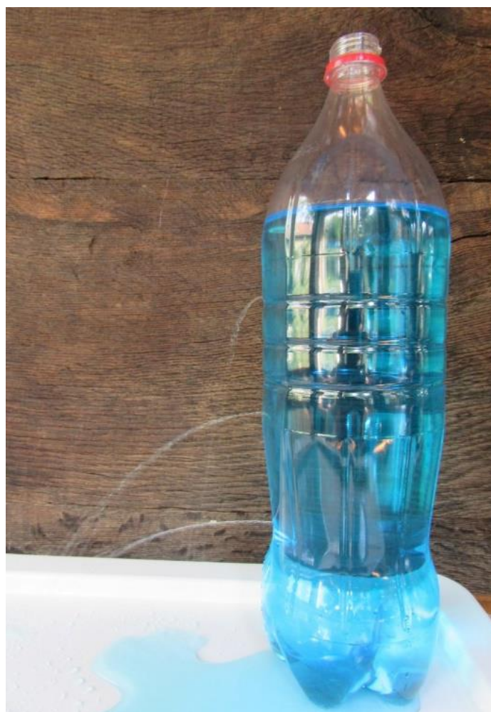
Slika 4.2. Plastična boca s 3 rupice na različitim visinama.
