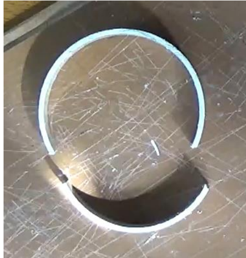
Slika 2.10. Ispiljeni kolut podijeli se na 3 jednaka dijela.
