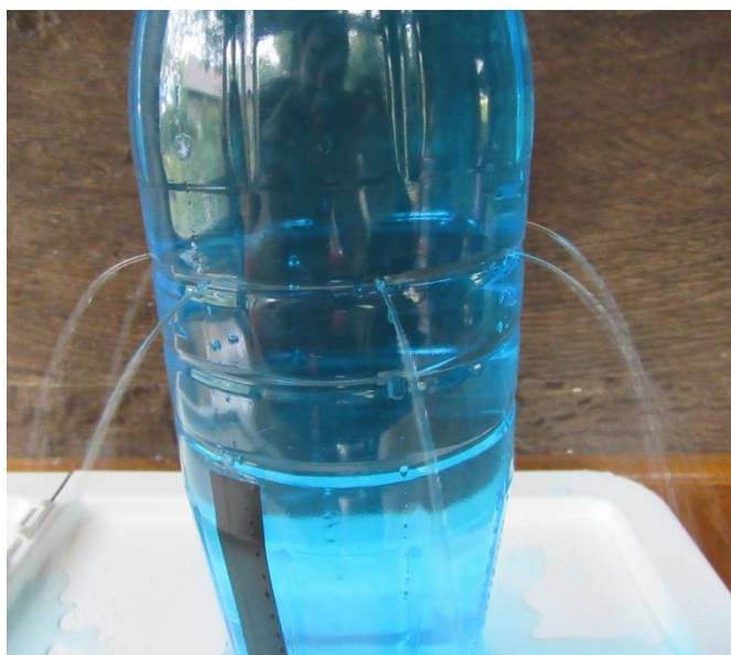
Slika 4.3. Plastična boca s rupicama na istoj visini.
