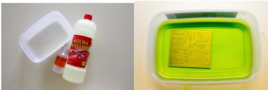
Slika 9 i 10 – Razvijanje pločice u otopini
