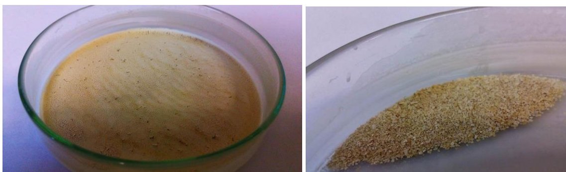
Slika 4.5. Osušene nanokockice CeO_2 (1. sinteza).
