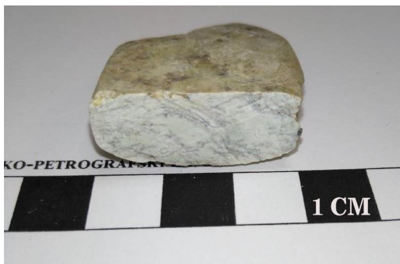
Slika 91. Prikaz presjeka uzorka L-4866. Na fotografiji su vidljive crne žile koje presijecaju cijeli uzorak bez preferirane orijentacije.
