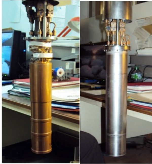
Slika 3.11: Nosač uzoraka se postavlja u bakarni štiti od termičkog zračenja, potom u komoru.
