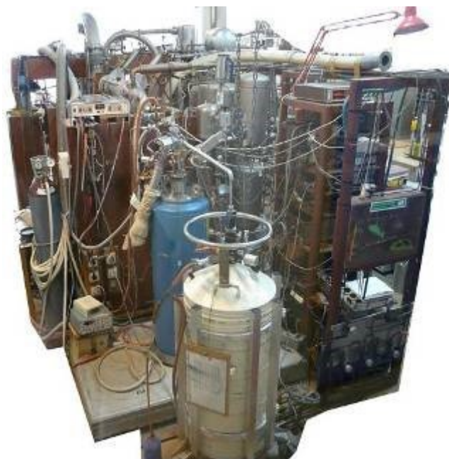
Slika 3.8: Dilucijski kriostat kućne izvedbe.
