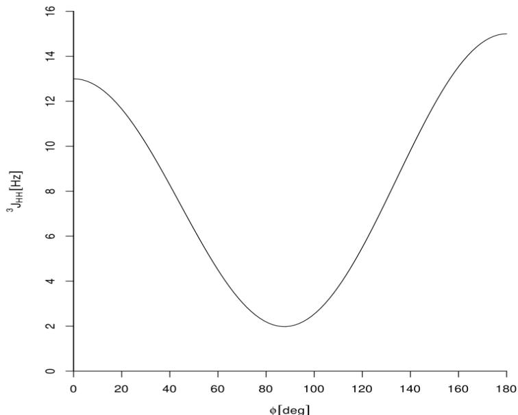
Slika 10. Grafički prikaz Karplusove jednadžbe,  $J_{HH}(\phi) = 12 \cos^2\phi - \cos\phi + 2$ , dobivene za derivate etana<sup>11</sup>
