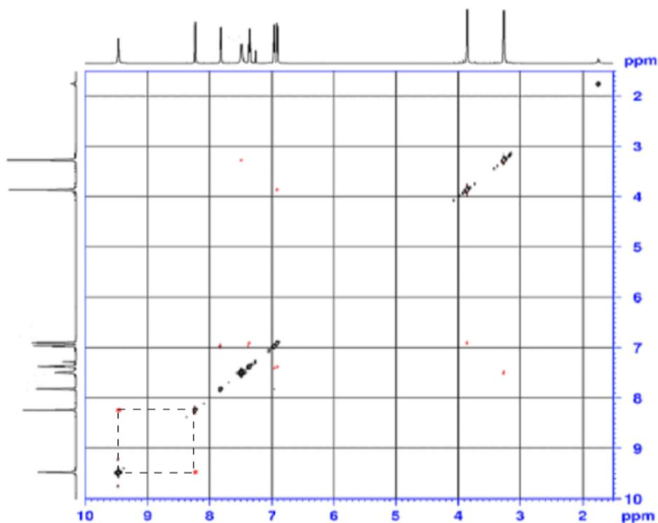
Slika 9. NOESY spektar 2-metoksibenzaldehid-4-metiltiosemikarbazona snimljen u deuteriranom kloroformu. Na osima se nalaze odgovarajući  $^1\text{H}$  spektri<sup>5</sup>
