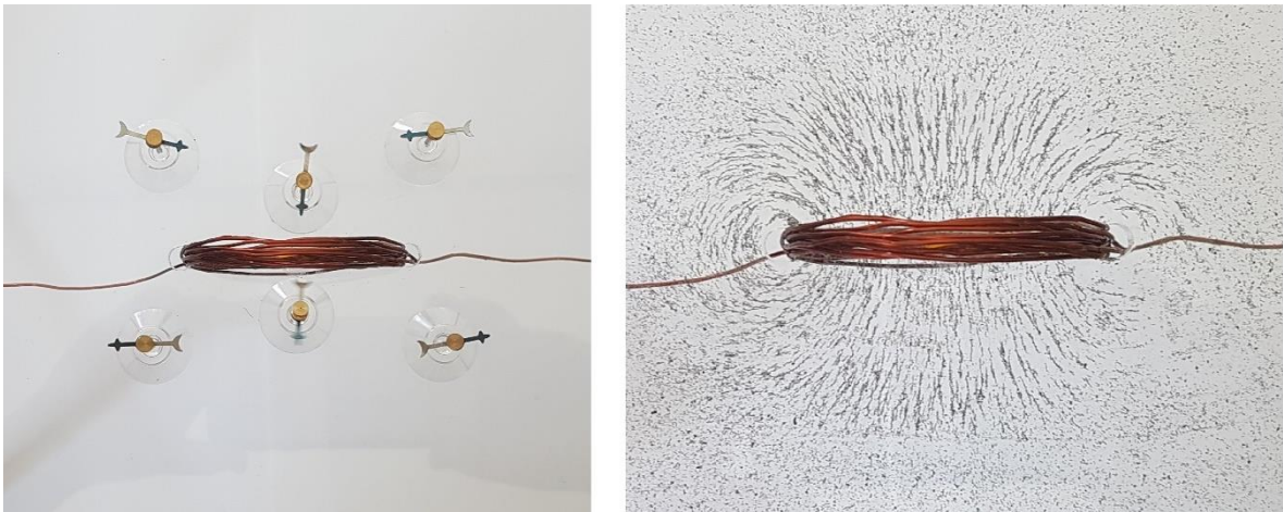
Slika 30 Magnetske iglice za vrijeme prolaska struje kroz ravni vodič (lijevo), silnice magnetskog polja dobivene pomoću željezne piljevine (desno)
