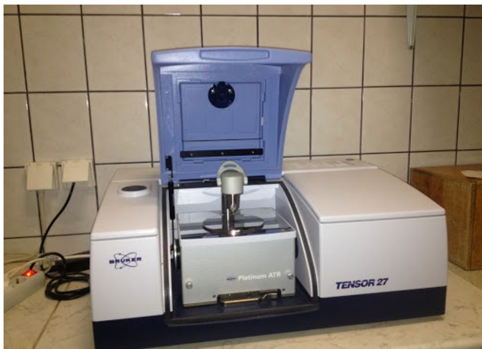
Slika 16. Tensor 27 spektrometar za snimanje FTIR spektra pripremljen za snimanje u ATR-u
