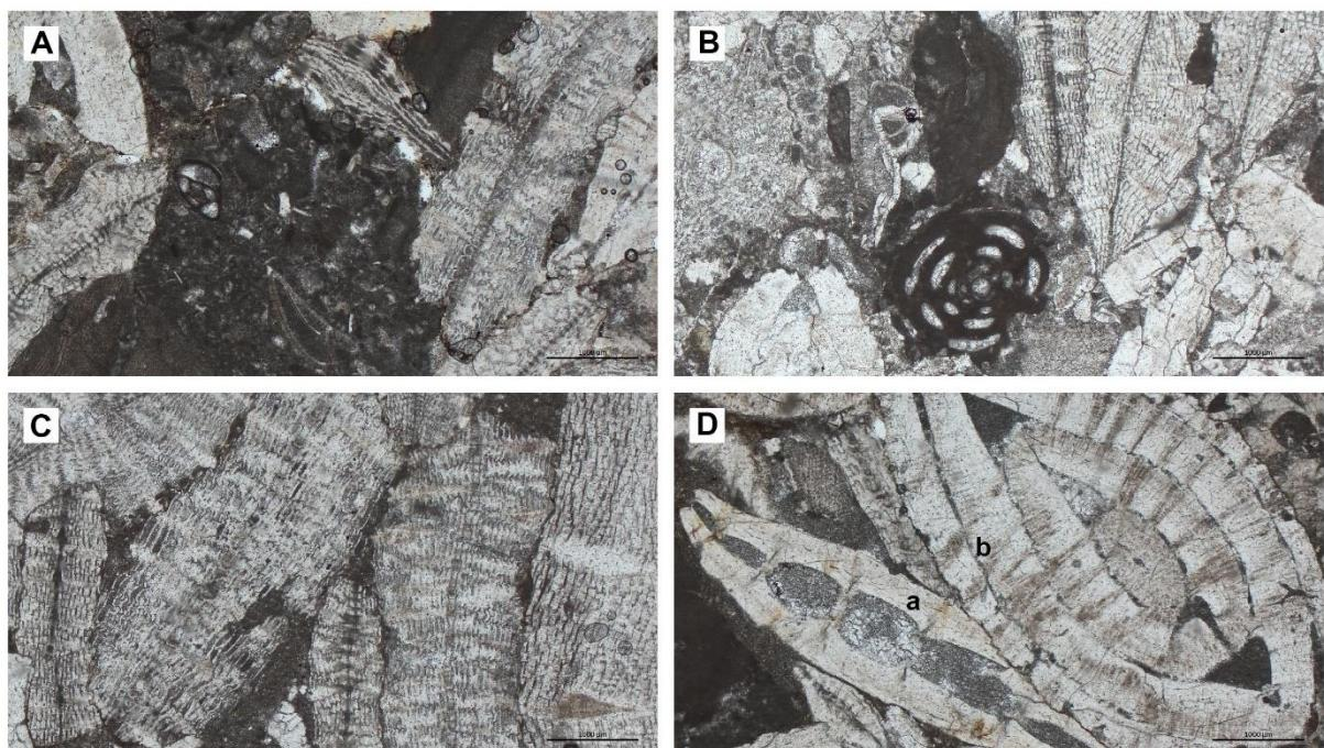
**Slika 61.** Mikrofotografije s glavnim konstituentima. **A)** biokalkrudit s litoklastom miliolidnog vapnenca. Uzorak Grimalda Ta, lokalitet Grimalda; **B)** biokalkrudit s litoklastom miliolidnog vapneca. Uzorak Zagrad gradina, lokalitet Kožljak; **C)** biokalkrudit s nasumičnim presjecima ortofragmina. Uzorak Grimalda Ta, lokalitet Grimalda; **D)** biokalkrudit s numulitima s involutnom (a) i evolutnom (b) kućicom. Uzorak Grimalda Ta, lokalitet Grimalda.
