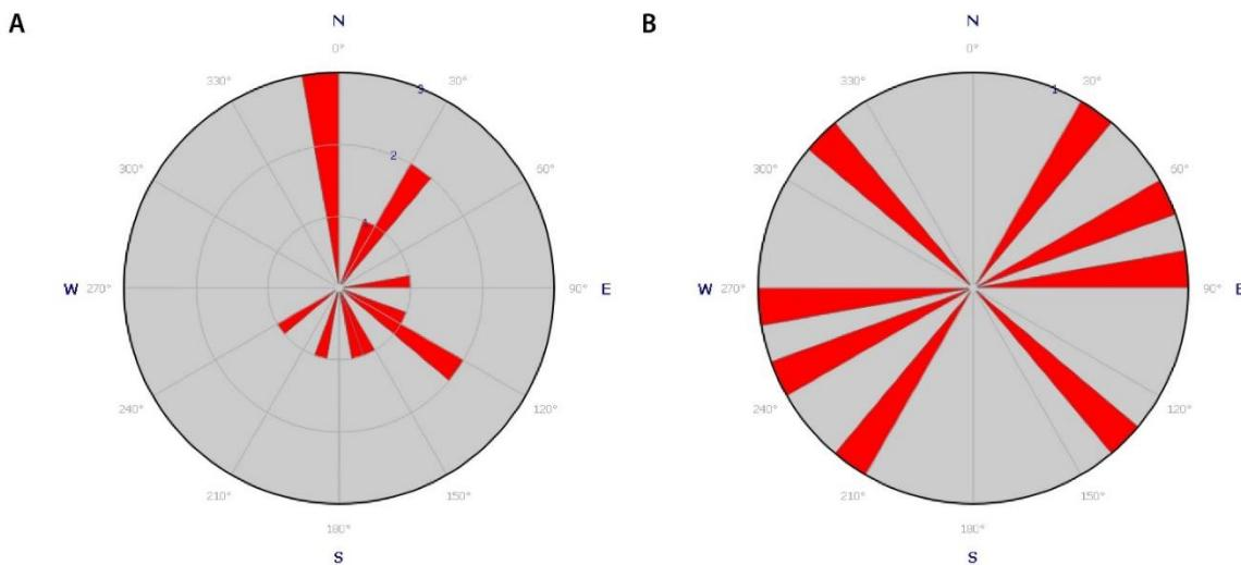
**Slika 67.** A) smjer paleotransporta dobiven na temelju mjerena tragova tečenja i orijentacije kresti riplova na gornjoj slojnoj površini karbonatnih slojeva. Ukupan broj mjerena  $n= 14$ ; B) smjer paleotransporta dobiven na temelju mjerena tragova vučenja na karbonatnim slojevima. Ukupan broj mjerena  $n= 4$ .
