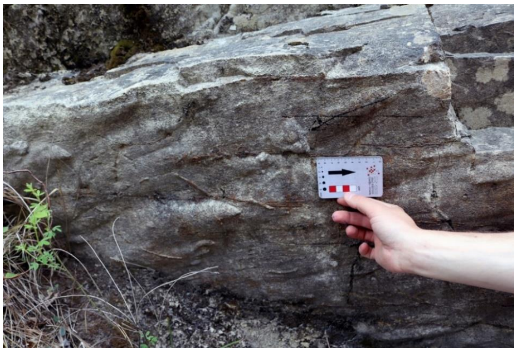
Slika 10. Mjerenje orijentacije tragova tečenja ( flute casts ).u svrhu određivanja smjera paleotransporta.
