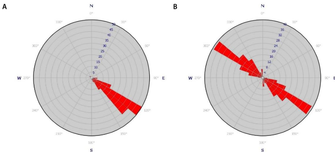
**Slika 66.** A) smjer paleotransporta dobiven na temelju mjerena tragova tečenja na miješanim siliciklastično-karbonatnim slojevima. Ukupan broj mjerena  $n= 151$ ; B) smjer paleotransporta dobiven na temelju mjerena tragova vučenja na miješanim siliciklastično-karbonatnim slojevima. Ukupan broj mjerena  $n= 125$ .
