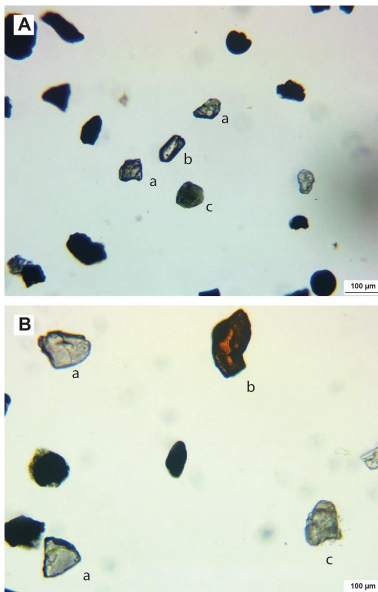
**Slika 65.** Mikrofotografije odabranih uzoraka teških minerala iz miješanih siliciklastično-karbonatnih slojeva. **A)** uzorak koji prikazuje granate (a), cirkon (b) i turmalin (c). Uzorak KAT-I 9, lokalitet Katun; **B)** teški minerali granati (a), rutil (b) i dolomit (c). Uzorak KAT-I 6, lokalitet Katun.
