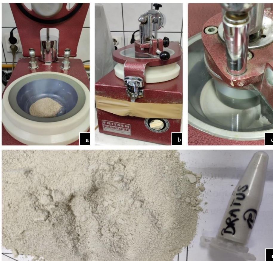
Slika 5. Mljevenje uzoraka na MPZ-u; a i b – priprema mlina; c – mljevenje; d - usitnjeni uzorak.
