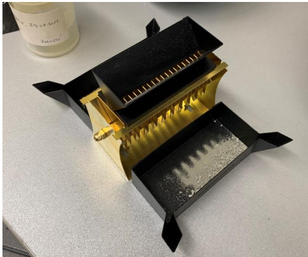
Slika 12. Standardizacija pod-uzorka metodom pačetvorenja (mikrosplitanja).
