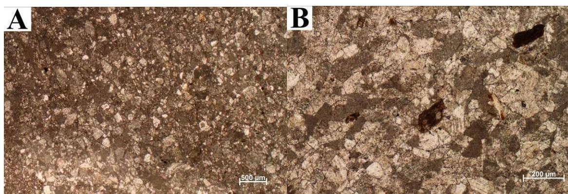
Slika 12. Mikroskopski preparati iz (A) uzorka MK1, kalksiltit uz prisutnost sparitnog cementa (B) uzorka MK4 kalkarenit uz prisutnost sparitnog cementa.
