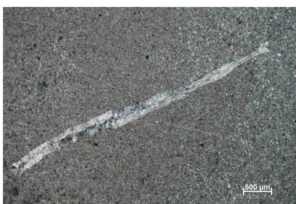
Slika 21. Mikroskopski izbrusak iz uzorka KA2, kalkarenit.
