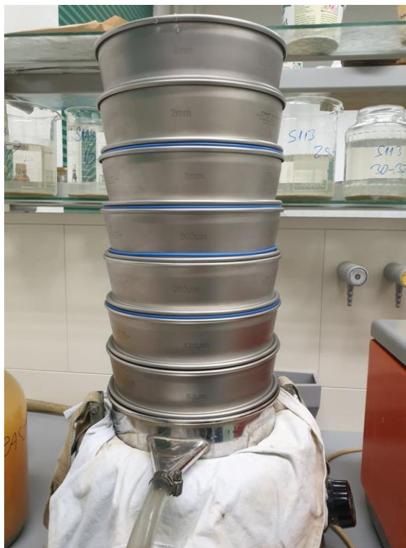
Slika 6. Sita za prosijavanje uzoraka s promjerima 4 mm, 2 mm, 1 mm, 0,5 mm, 0,25 mm, 0,125 mm i 0,063 mm. Fotografirala Stella Šušnjar.
