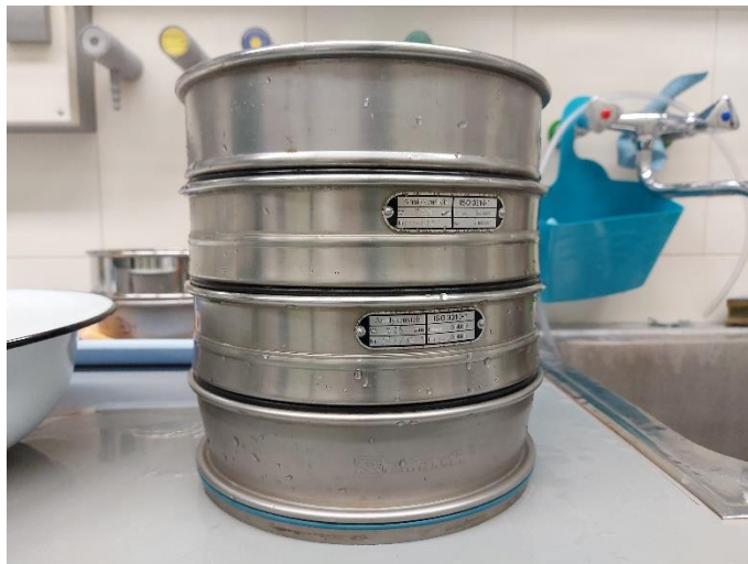
Slika 5. Četiri sita promjera mrežice 500, 250, 125 i 63 \mu m
