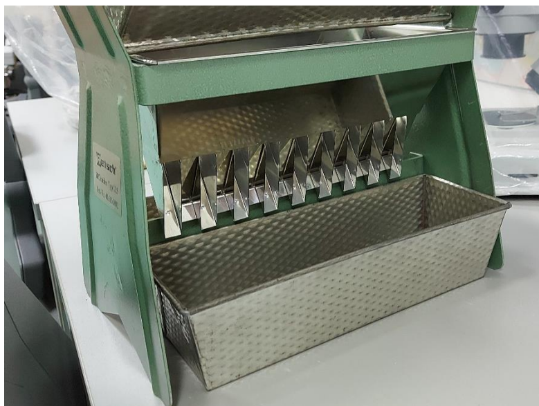
Slika 6. Mikrospliter korišten za standardizaciju uzorka
